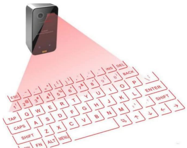
A virtual (laser) keyboard
